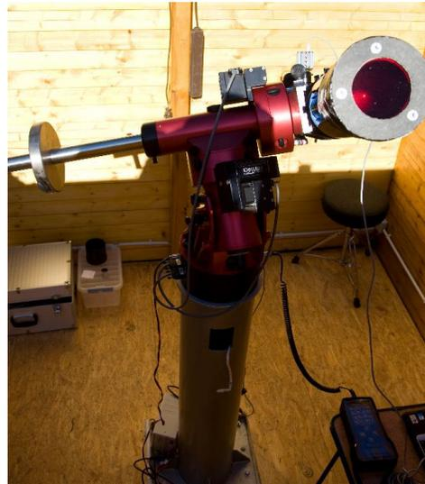
Abbildung 3: Der TMB 115/805 mit Baader C-ERF Sonnenfilter auf der GM2000 mit Selbstbau-Stahlsäule.
