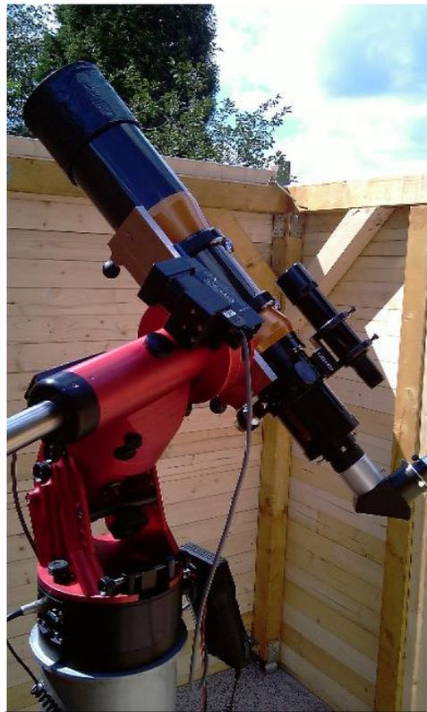
Abbildung 1: 4,5" TMB APO auf GM2000 QCI Ultraport mit Stahlsäule.
